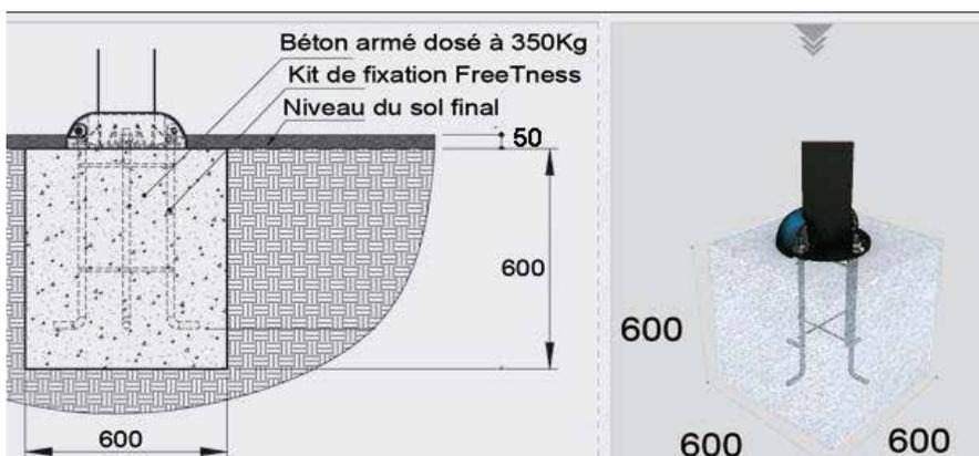
Effectuer les fouilles selon le plan (600mm x 600mm x 600mm). Positionner le kit de fixation dans le béton frais. Laisser dépasser de 5cm les tiges filetées. Vérifier le niveau du plot béton et du kit une fois celui-ci placé dans le béton. Essuyer les projections de béton sur le filetage utile.
