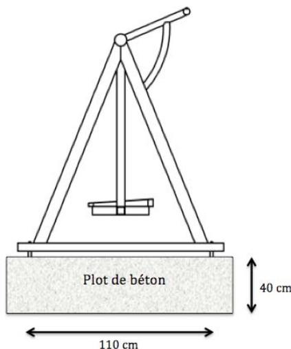
Couler une dalle de 2m20 par 1m20 par 10cm de profondeur ou 2 bandes de béton (une à gauche et une à droite de l'appareil) aux dimensions suivantes : 110cm de long, 30cm de large et 40 cm de profondeur.
