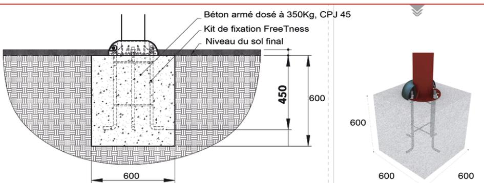
Effectuer les fouilles selon le plan (600mm x 600mm x 600mm). Positionner le kit de fixation dans le béton frais. Laisser dépasser de 5cm les tiges filetées. Vérifier le niveau du plot béton et du kit une fois celui-ci placé dans le béton. Essuyer les projections de béton sur le filetage utile.
