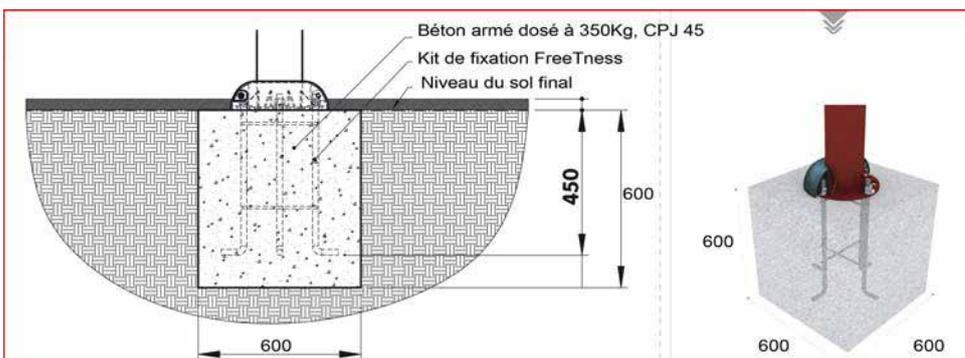
Effectuer la fouille principale selon le plan (600mm x 600mm x 600mm). Positionner le kit de fixation dans le béton frais. Laisser dépasser de 5cm les tiges filetées. Vérifier le niveau du plot béton et du kit une fois celui-ci placé dans le béton. Essuyer les projections de béton sur le filetage utile.
