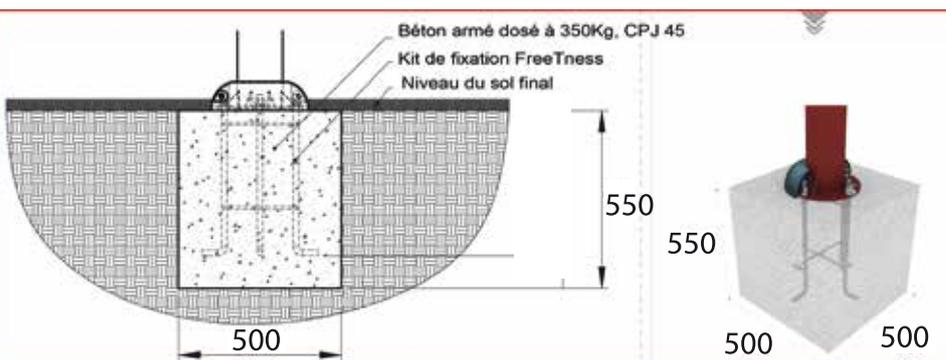
Effectuer les fouilles selon le plan (550mm x 500mm x 500mm). Positionner le kit de fixation dans le béton frais après vérification de celui-ci (voir page suivante). Laisser dépasser de 5cm les tiges filetées. Vérifier le niveau du plot béton et du kit une fois celui-ci placé dans le béton. Essuyer les projections de béton sur le filetage utile.
