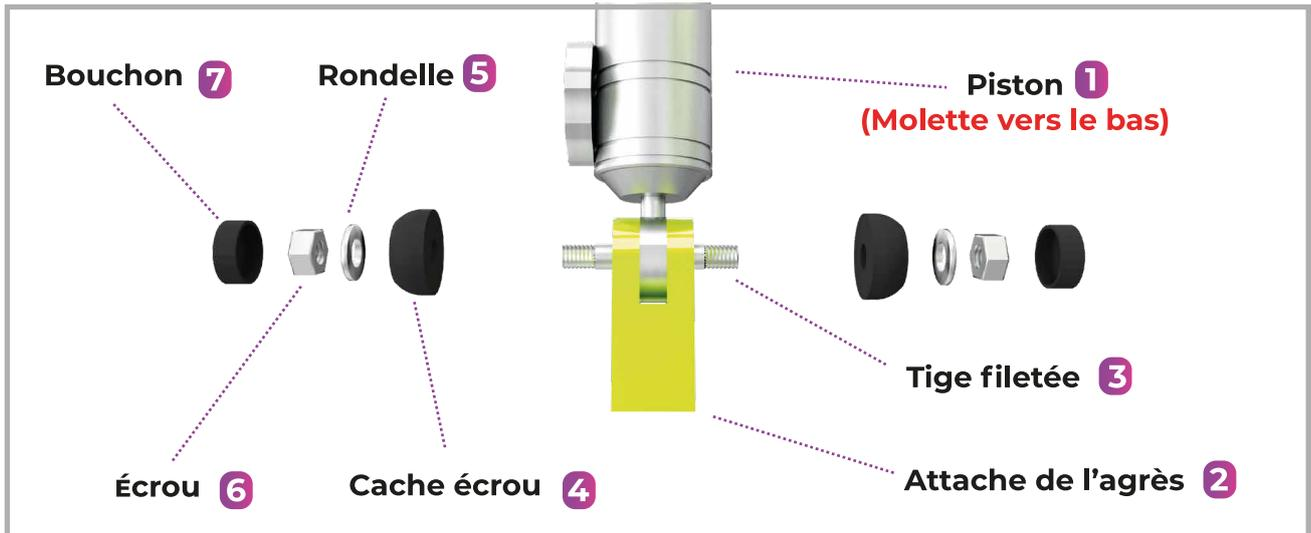
Prenez le piston **1** et positionnez-le dans les attaches **2** prévues à cet effet. Insérez la tige filetée **3** pour fixer le piston, Mettre le cache écrou **4**, insérez la rondelle **5**, serrez avec l'écrou **6**, puis mettez le bouchon. **7**
