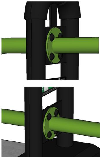
Vissez les côtés Push et Pull de l'appareil sur la double potence comme sur le plan ci-dessus avec la visserie fournie.
