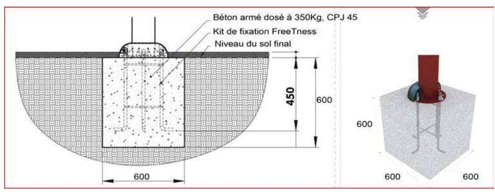
Effectuer la fouille principale selon le plan (600mm x 600mm x 600mm). Positionner le kit de fixation dans le béton frais. Laisser dépasser de 5cm les tiges filetées. Vérifier le niveau du plot béton et du kit une fois celui-ci placé dans le béton. Essuyer les projections de béton sur le filetage utile.
