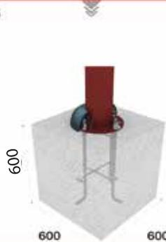
Effectuer les fouilles selon le plan (600mm x 600mm x 600mm). Positionner le kit de fixation dans le béton frais après l'avoir vérifié (voir page suivante). Laisser dépasser de 5cm les tiges filetées. Vérifier le niveau du plot béton et du kit une fois celui-ci placé dans le béton. Essuyer les projections de béton sur le filetage utile.
