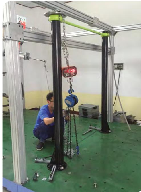
Chargée en son point le plus faible, la plus longue de nos barres (2 mètres) supporte la pression **jusqu'à 1 tonne** ! L'acier se déforme mais le système ne cède pas !
